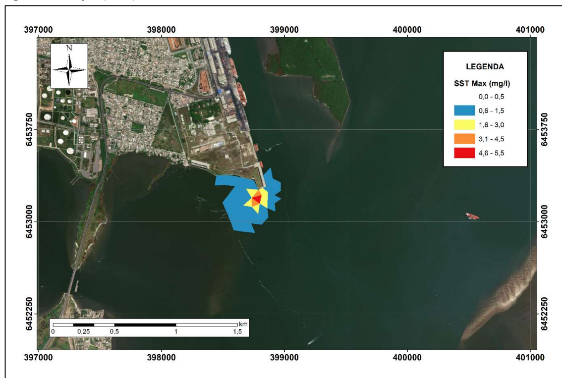
Figura 14. Distribuição espacial da concentração máxima de Sedimentos Suspensos Totais (SST) / Turbidez ao longo da simulação (AWT).
