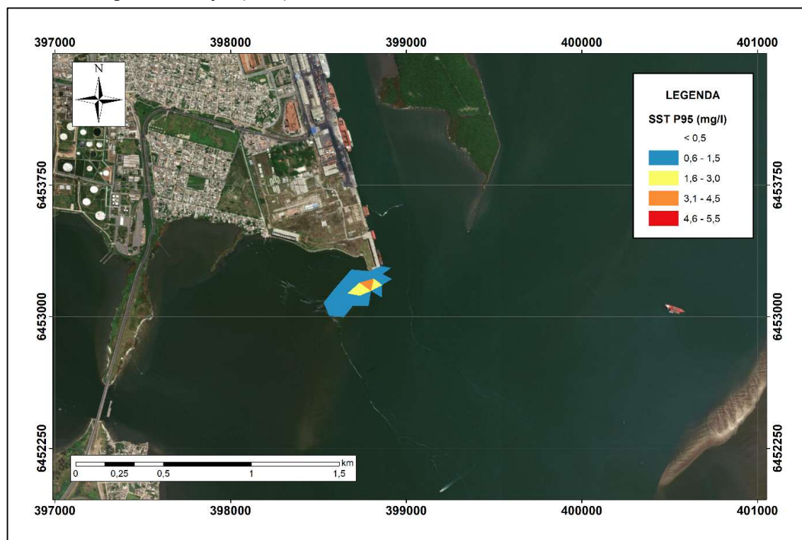
Figura 15. Distribuição espacial do percentil 90 da concentração de Sedimentos Suspensos Totais (SST) / Turbidez ao longo da simulação (AWT).
