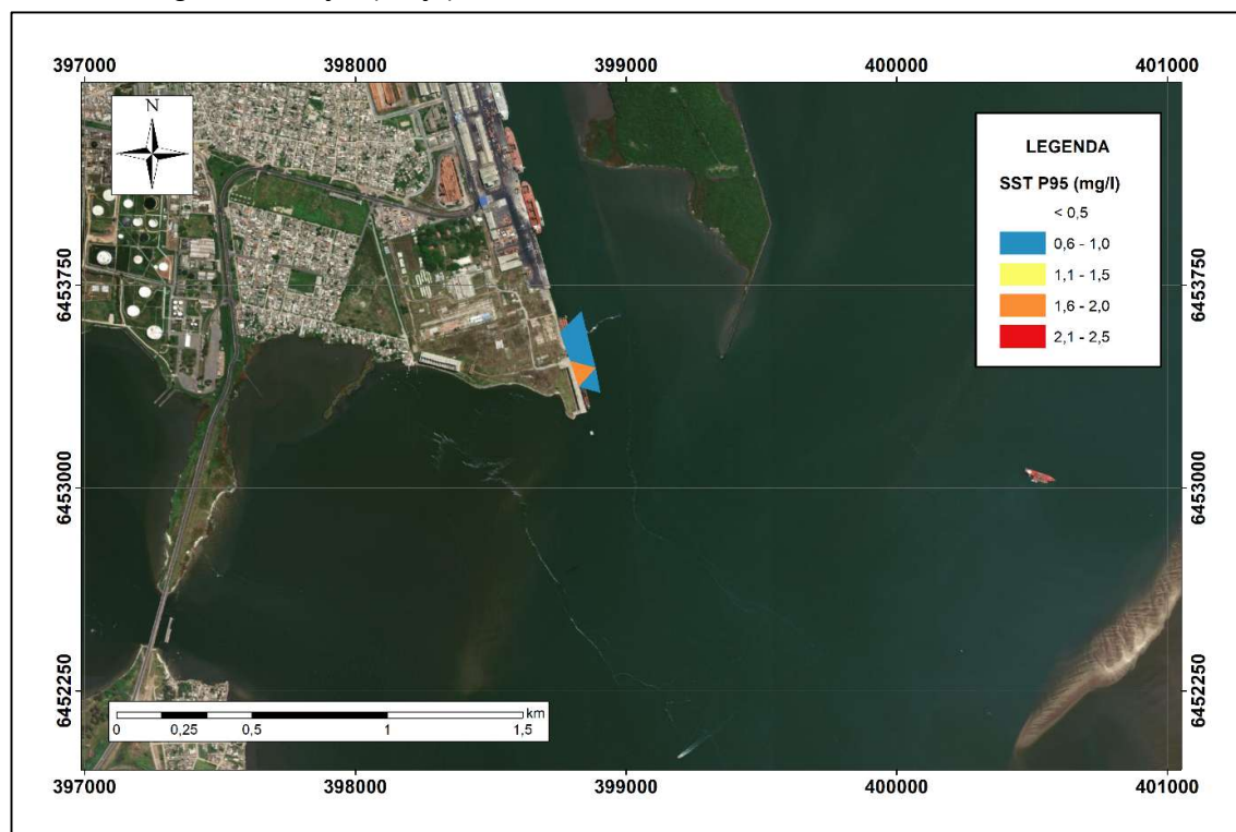
Figura 10. Distribuição espacial do percentil 90 da concentração de Sedimentos Suspensos Totais (SST) / Turbidez ao longo da simulação (Berço)
