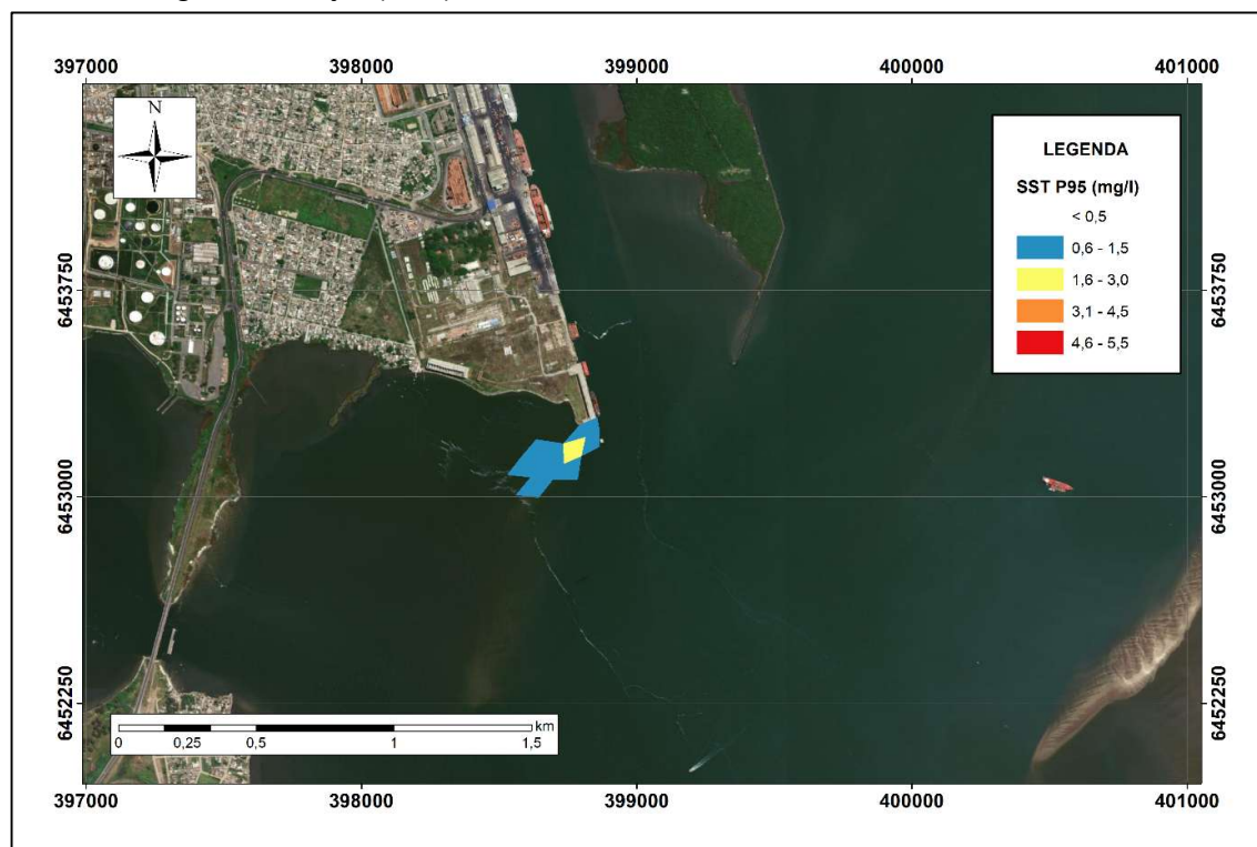
Figura 16. Distribuição espacial do percentil 95 da concentração de Sedimentos Suspensos Totais (SST) / Turbidez ao longo da simulação (AWT).
