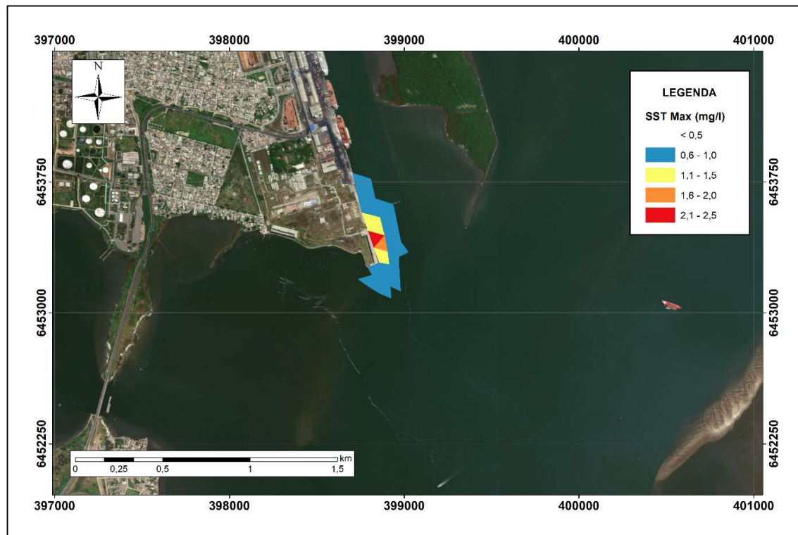
Figura 9. Distribuição espacial da concentração máxima de Sedimentos Suspensos Totais (SST) / Turbidez ao longo da simulação (Berço).
