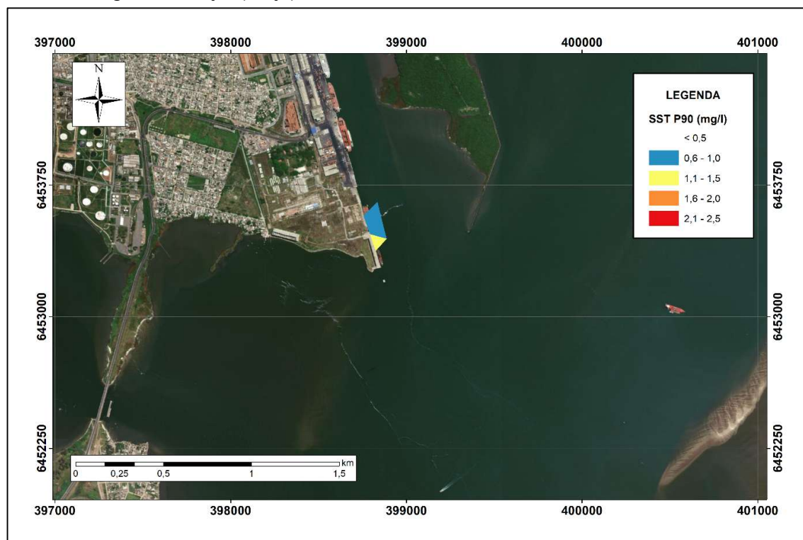
Figura 11. Distribuição espacial do percentil 95 da concentração de Sedimentos Suspensos Totais (SST) / Turbidez ao longo da simulação (Berço).
